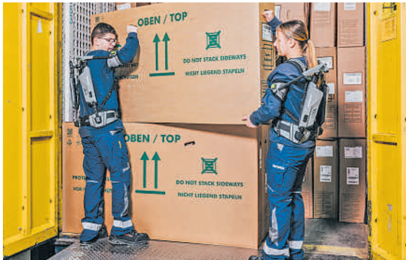
Bei großen Paketen tragen die Mitarbeitenden Exoskelette, die das Heben unterstützen, wodurch weniger Kraft nötig ist. Fotos: Dachser
