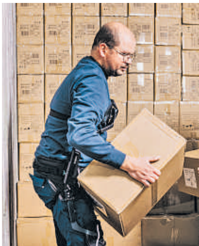
Fabian Hahn nutzt ein passives Exoskelett.
