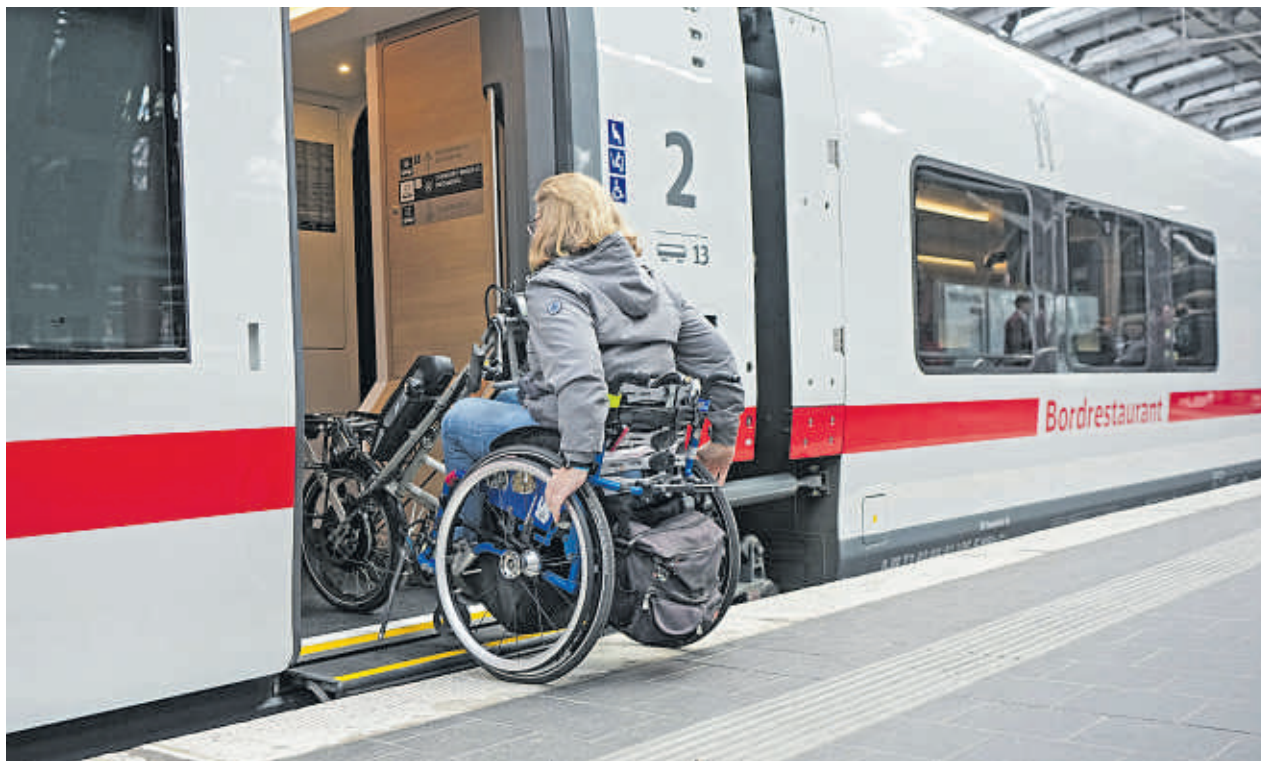
Auch mit einem Rollstuhl lässt sich problemlos in den ICE L einsteigen. Das funktioniert allerdings nur an Bahnsteigen des Fernverkehrs, die in der Regel 76 Zentimeter hoch sind.
