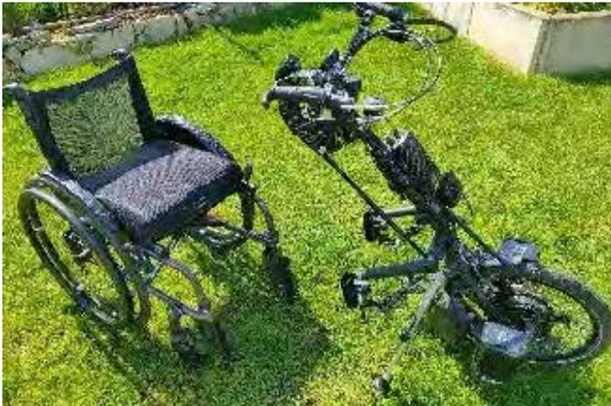
*Das elektrische Rollstuhlzuggerät ermöglicht dem Nutzer mit einer Handkurbel, den Antrieb mit eigener Kraft zu unterstützen.*
